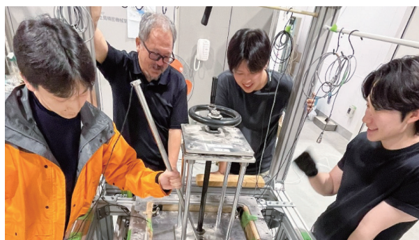
河井研究室の様子 (箱の中に土を詰めてコーン貫入試験を行う前の作業打ち合わせ中)
