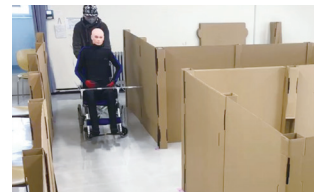
自動運転車いすの建物内の移動方法の模擬実験
