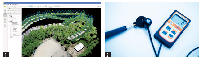
1 長町キャンパス内の森林をドローンで撮影した大量の画像から、写真測量ソフトウェアを使って高精度の3Dマップを制作 2 太陽からの放射されるエネルギーを測定するハンディ型小型日射計
