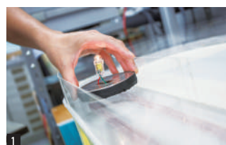
1 ワイヤレス給電による電球の点灯実験
