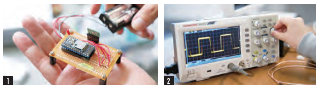
1 ローコストで、ワイヤレスセンサネットワークを学ぶのに最適なZigBee無線端末 2 オシロスコープで電波の波形を確認
