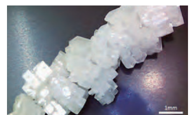
再結晶化させた立方体状のTlBr結晶
