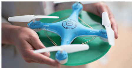
ワイヤレスの受送電システムによる省電力ドローンとコイル盤
