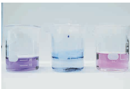
水溶液中でのアルデヒド類と試薬の反応
