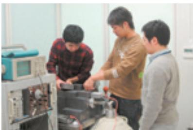
ゲルマニウム検出器を用いた放射能測定
