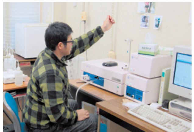
凝集を荷電中和能力の観点から評価するためのZ電位の測定
