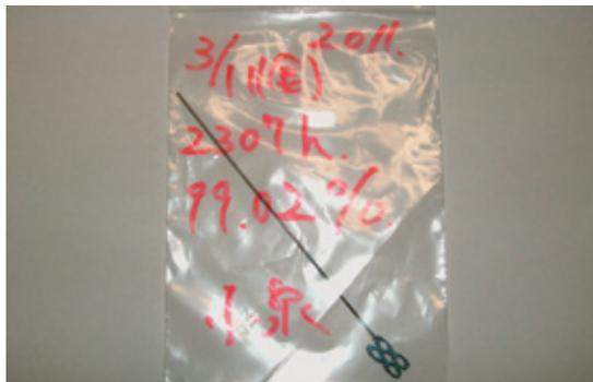
海水電解のための酸素発生電極の試料
